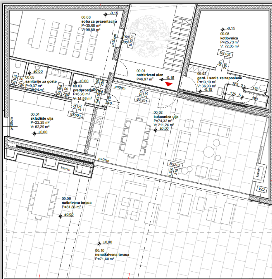
Slika 8. Tlocrt prizemlja Građevine 1 – kušaonice ulja
